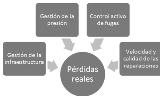
**Figura 1.-** Los cuatro métodos de intervención principales para la reducción de pérdidas reales de agua, según la IWA.
