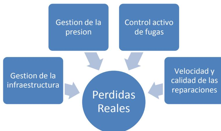
**Figura 2** – Métodos de intervención para la reducción de Pérdidas Reales de Agua
