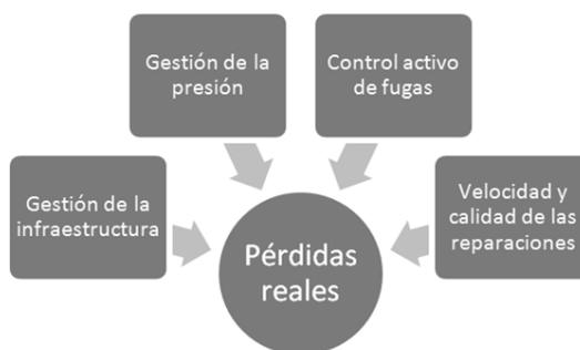
**Figura 1** - Los cuatro métodos principales de intervención para la reducción de pérdidas reales de agua, según la IWA.
